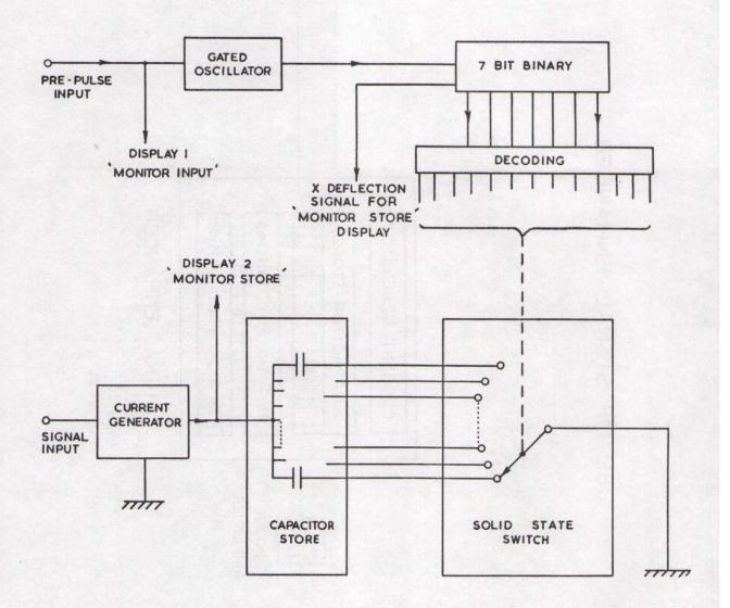
CAPACITOR SIGNAL-ENHANCER - SIMPLIFIED BLOCK DIAGRAM.
